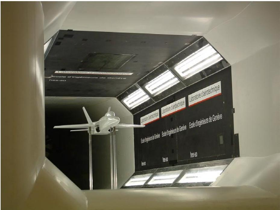
Montage d'un modèle sur pilônes motorisés
