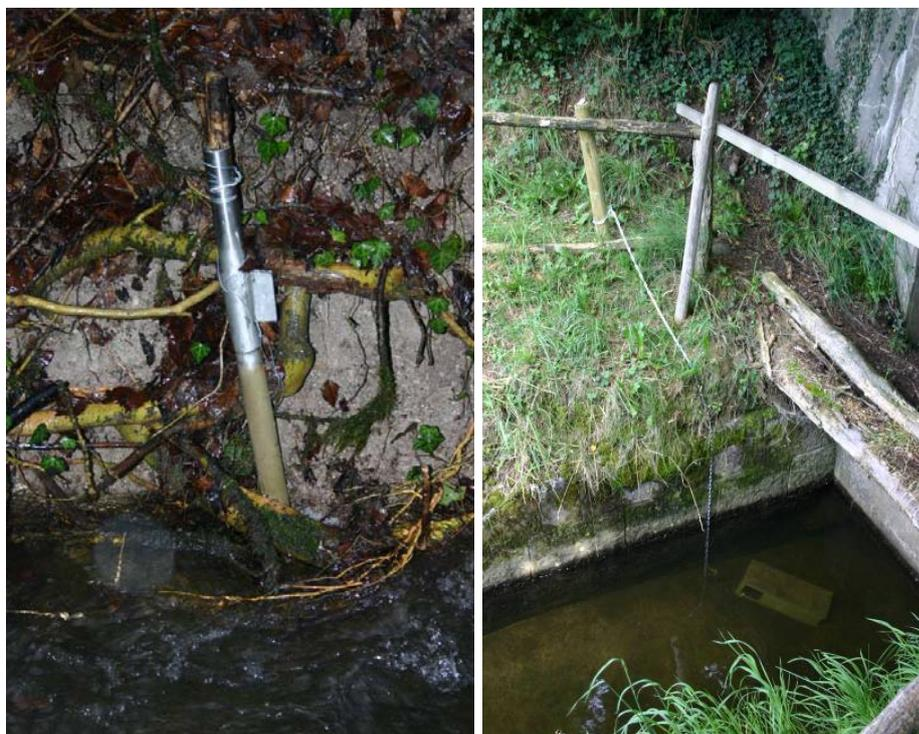
**Figure 25: A gauche, tube de protection d'un enregistreur de température. A droite enregistreur lesté par une brique en béton**
