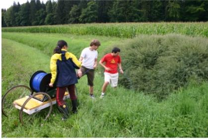
La température de l'eau a été mesurée grâce à une fibre optique (DTS instrument Agilent N43386A, duplex mode 50/125 BRU steel fiber optic cable Bruggs) avec une résolution de 1.5 m et un pas de temps de 10 m.
