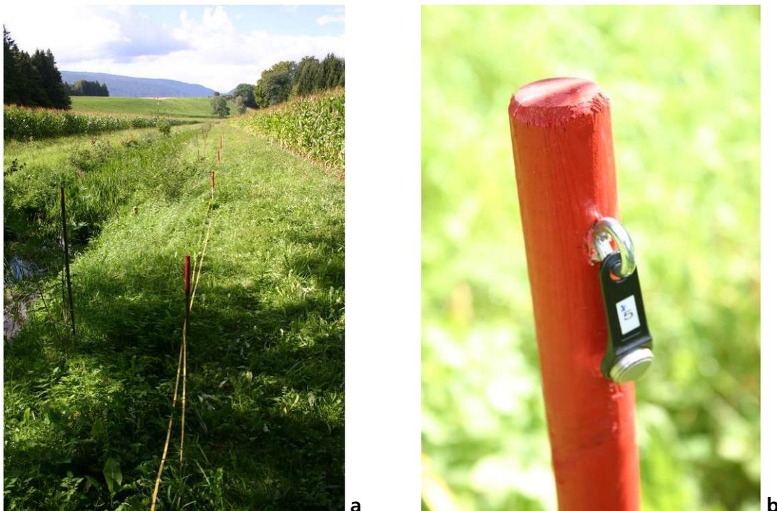
**Figure 28 :** Dispositif mis en place le long du Boiron de Morges (a), avec enregistreur de température (b), pour estimer la large efficacité de cordon boisé
