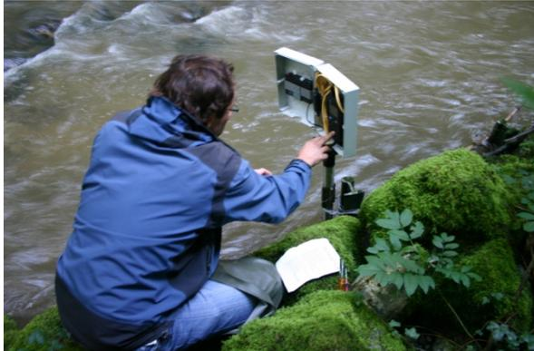
La concentration en oxygène (mg/l, % de saturation) a été mesurée toute les 30 minutes du 23 mai 2008 au 14 octobre 2008 (Figure 26). La station de mesure se trouvait à Lully au même emplacement que l'enregistreur de température n°14.
