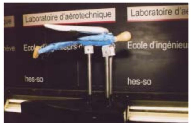
*Test en soufflerie sur une voilure gonflable*
