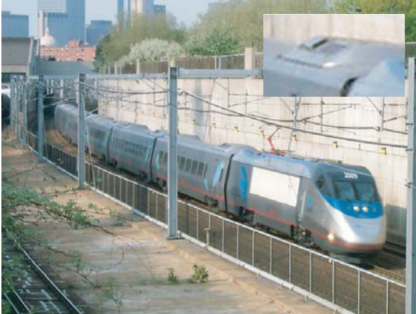
Exemple de prises d'air d'unités de climatisation situées dans des régions à C_p < 0 (North East Corridor High Speed Train - Acela)
