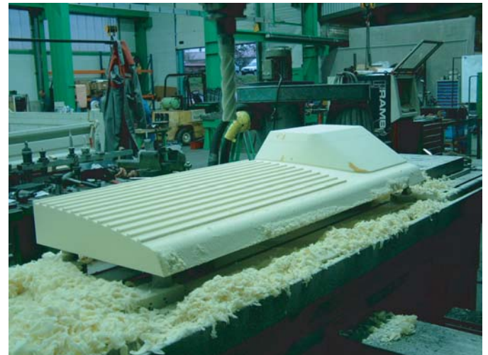
Usinage de la maquette sur une machine-outils 5 axes à partir de fichiers CAO / CAD
