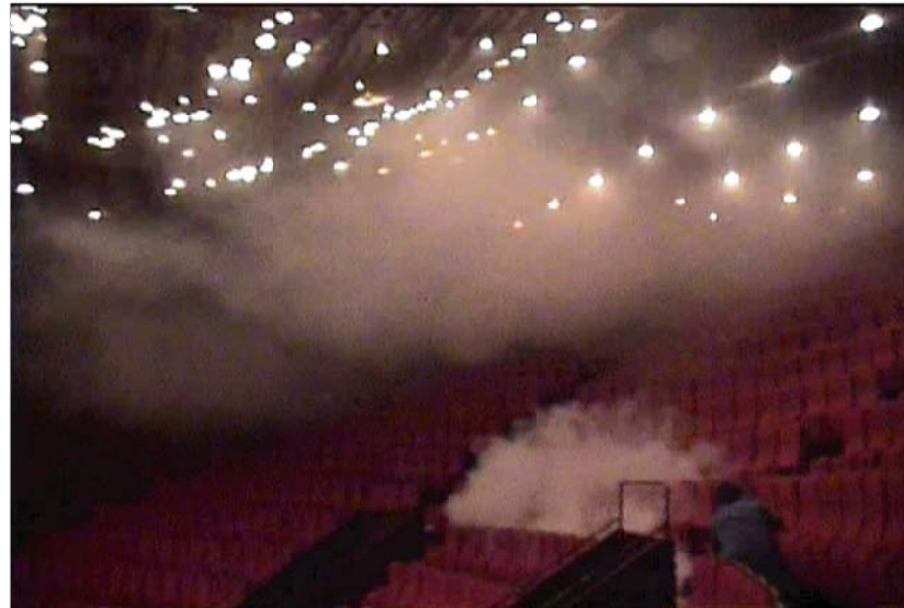
Visualisation des mouvements convectifs à l'aide de fumée
