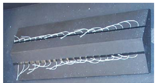
Ecoulement au voisinage de la verrière
