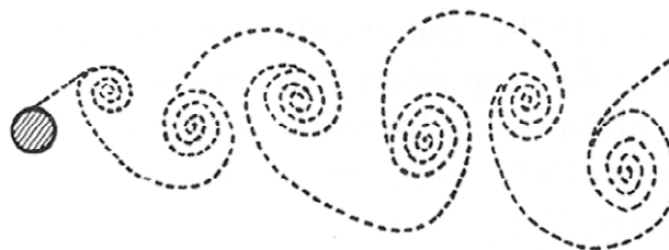
Figure 4 : Sillage en aval d'un cylindre (ref. 4)
